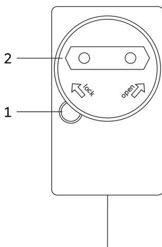
Drücken Sie den Feststellknopf (1) und halten diesen gedrückt. Währenddessen drehen Sie die Adapterplatte (2) gegen den Uhrzeigersinn um diese vom Netzteil zu entfernen.
